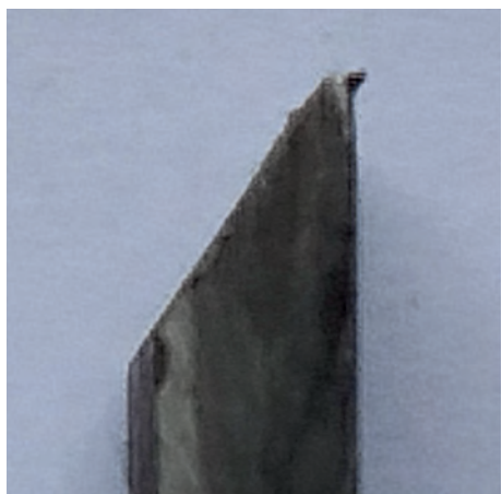
Рисунок 4 – Характер втрати різальної робочої частини ножа зі сталі 45 гартована
