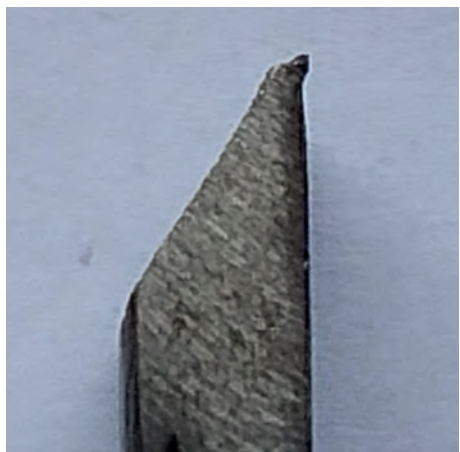
Рисунок 2 – Характер втрати різальної здатності робочої частини ножа зі сталі 45 без гартування
