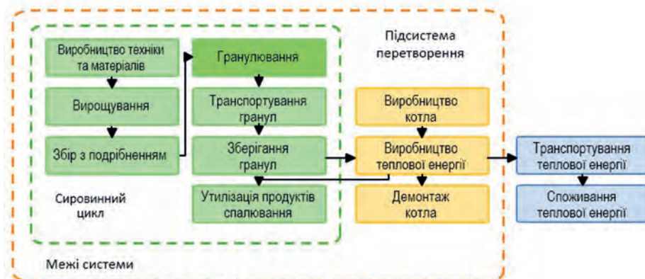
Рисунок 2 – Схема і межі життєвого циклу виробництва теплової енергії з гранул енергетичних рослин
