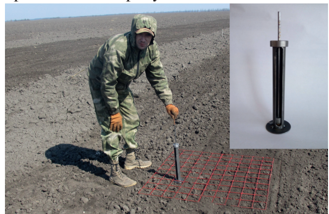
Рисунок 3 – Визначення ущільнення ґрунту методом падаючого конуса
