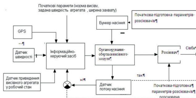
Рисунок 4 – Схема управління технологічними процесами в лабораторних і польових дослідженнях
