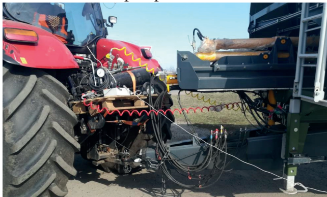
Рисунки 4 – Імітатор гальмування, встановлений на тракторі
