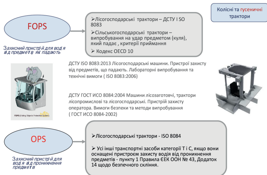
Рисунок 7 – Усунення ризиків від потенційної небезпеки від предметів, які падають та проникають під час виконання робіт за нормального експлуатування
