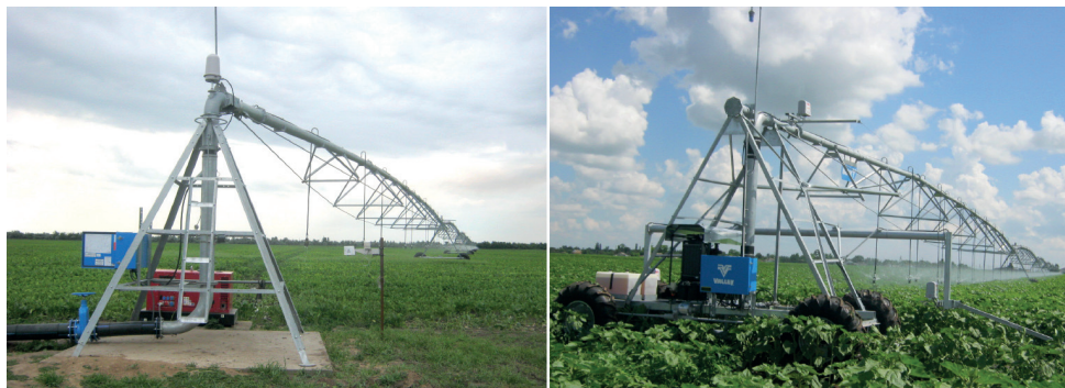
Рисунок 6 – Багатоопорні дощувальні машини марки Valley (А – кругової дії, Б – фронтальної дії)
