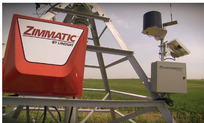
Рисунок 8 – Метеостанція Growsmart у складі дощувальної машини
