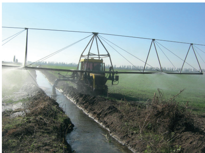
Рисунок 1 – Дощувальний агрегат ДДА-100М в роботі
