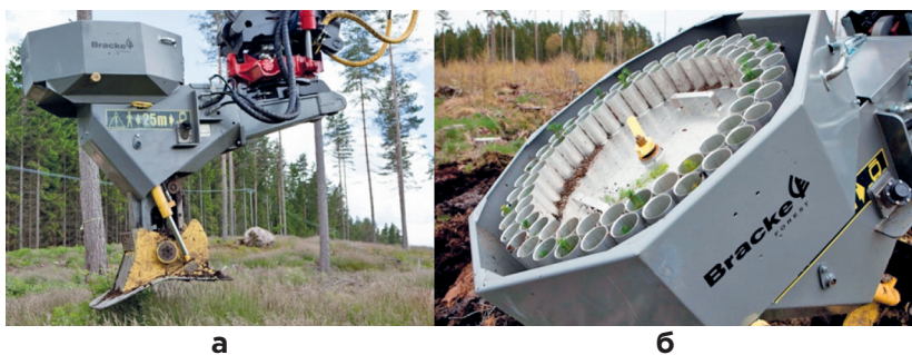
а – загальний вигляд; б – бункер револьверного типу
