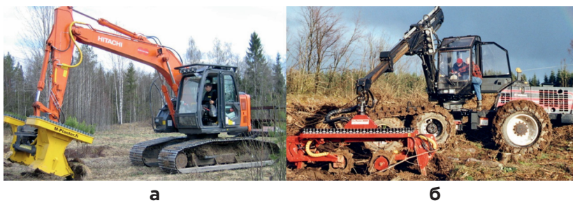
Рисунок 4 – Саджальні головки моделей M-Planter-M (а) та EcoPlanter (б)
