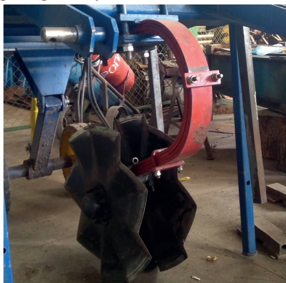
Рисунок 2 – Загальний вигляд стійки регульованої жорсткості виробництва ТОВ «АГРОРЕММАШ-БЦ»
