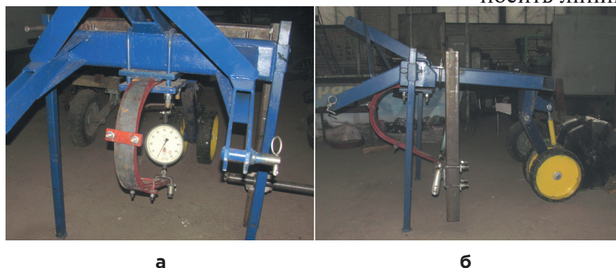
Рисунок 3 – Вигляд стенда з динамометром та гвинтами для забезпечення зусиль переміщень у вертикальній (а) та горизонтальній (б) площинах
