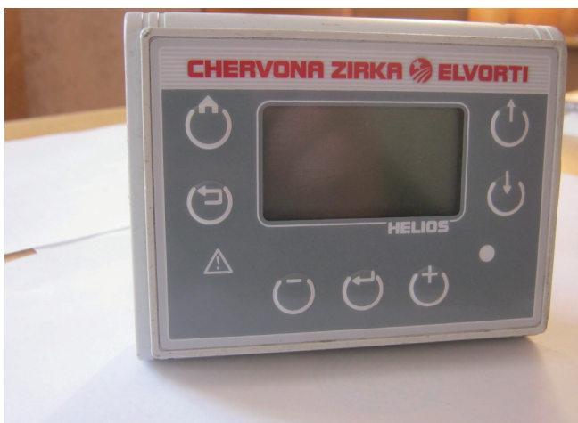
Рисунок 5 – Пульт системи керування і контролю висіву
