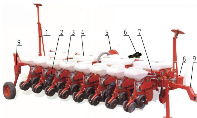
1 – маркер; 2 – опорно-приводне колесо; 3 – посівна секція; 4 – туковисівна система; 5 – вентилятор; 6 – вал карданний; 7 – рама; 8 – вантаж; 9 – транспортний пристрій
