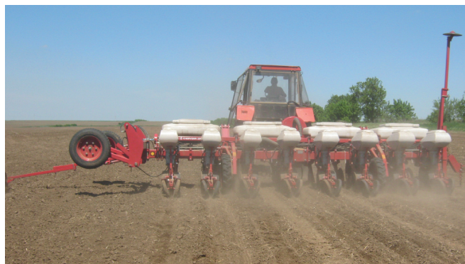
Рисунок 6 – Сівалка «Vega-8» з електроприводом висівних апаратів на сівбі за традиційною технологією
