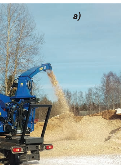
Рисунок 2 – Самохідні комбіновані подрібнювачі деревини на шасі форвардерів «Bruks 806.3 STC» (а) та «Dutch Dragon EC6060» (б)
