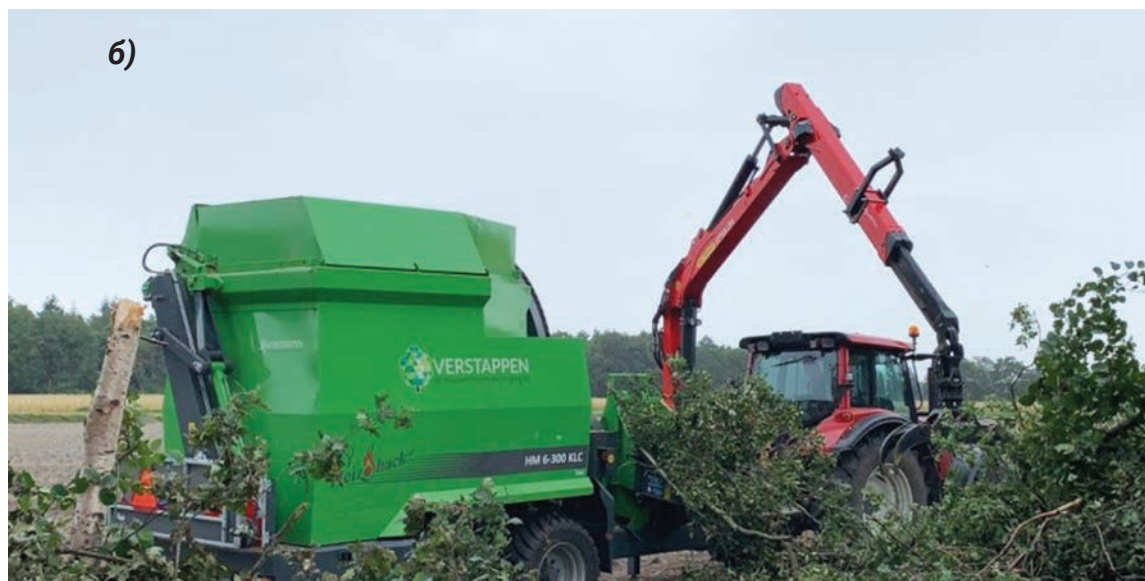
Рисунок 3 – Причіпні комбіновані подрібнювачі деревини «Greentec Cheetah 30/8» (а) та «HM 6-300 KLC» (б)
