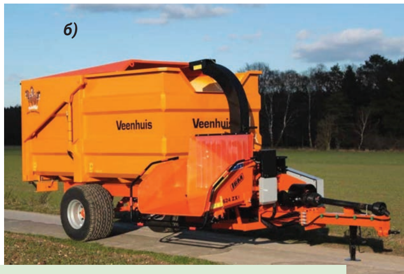
Рисунок 4 – Комбіновані деревоподрібнювачі «Skorpion 350 RBP» (а) та «Combo JBM 624 ZX» (б)
