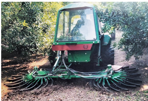
Рисунок 11 — Механізація процесу збирання горіхів після їхнього струшування
