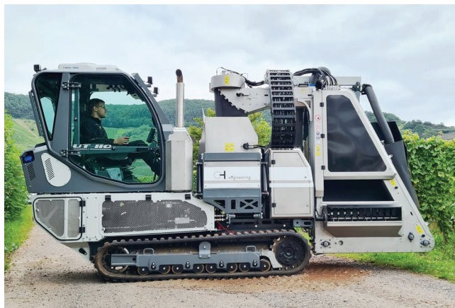
Рисунок 22 — Виноградозбиральний комбайн «UT 10-CH 500»
