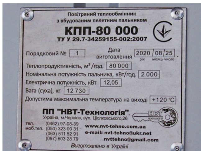
Рисунок 4 — Маркувальна табличка теплообмінника «КПП-80000» зі знаком відповідності вимогам Технічного регламенту безпеки
