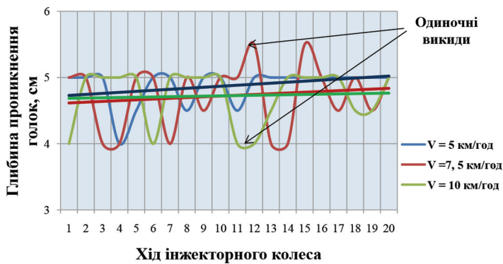
Динаміка меж проникнення голок в ґрунт по ходу інжекторного колеса за різної швидкості руху машини
