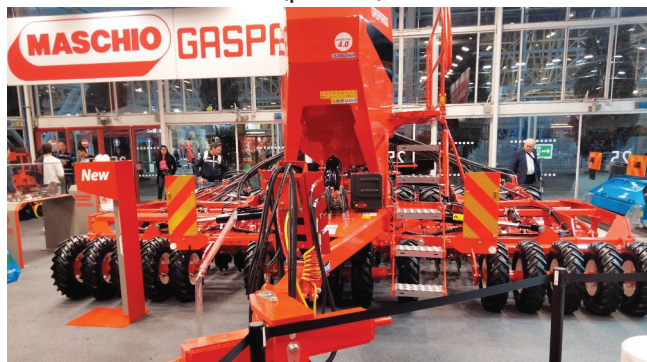
Рисунок 16 — Вигляд сівалки точної сівби «Opera 600» фірми «Maschio Gaspardo» з централізованим бункером, висівними апаратами CHRONO та системою управління «ISOTRONIK»
