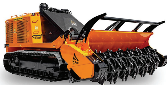
Рисунок 27 — Загальний вигляд машини «PT-300 D:MINE» і її робочий орган
