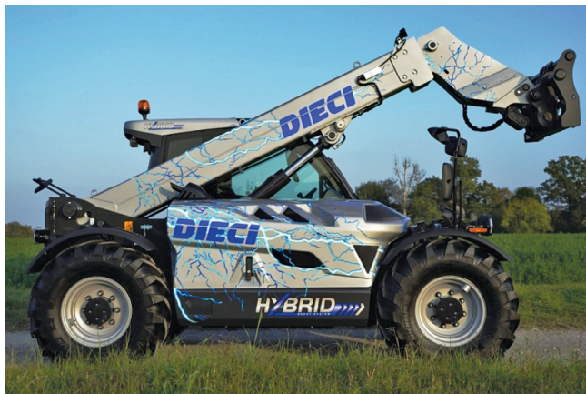
Рисунок 19 — Телескопічний навантажувач «DIECI GIBRID» з гібридною оптимізованою системою керування
