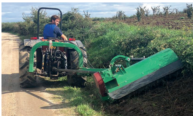
Рисунок 12 — Робота молоткової косарки фірми «FACMA» на похилій площині
