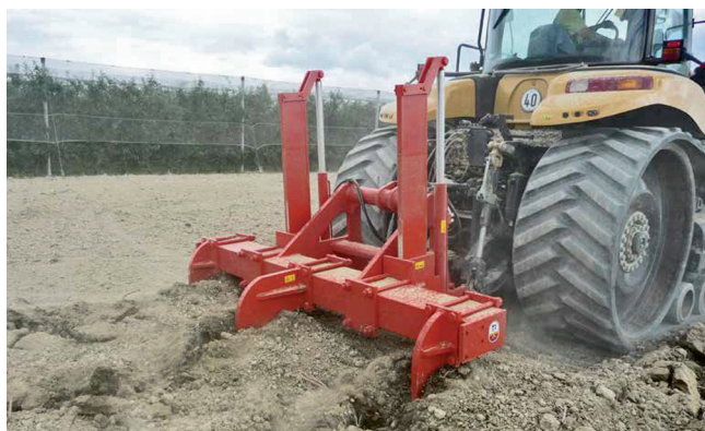
Рисунок 14 — Глибокорозпушувач фірми «SPADA&GATTI» дворежимної дії (щільноутворювач-чизель)
