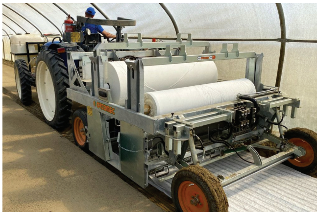
Рисунок 24 — Комбінована двоярусна мульчувально-посівна машина
