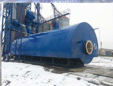
БІОТЕПЛОГЕНЕРАТОРНИЙ КОМПЛЕКС РОЗДІЛЬНО- БЛОЧНОГО ТИПУ
