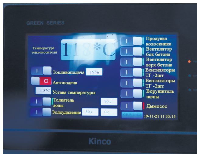
Рисунок 8— Сенсорна панель системи автоматизації відображує основні параметри та режими роботи теплогенератора
