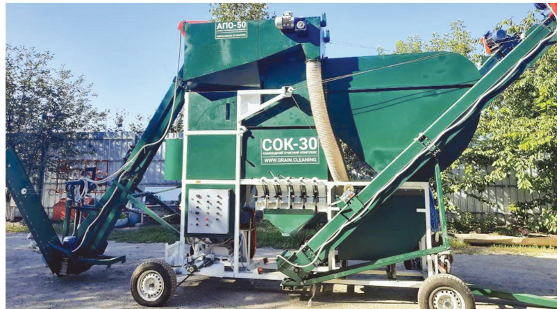
Рисунок 1 — Загальний вигляд мобільного зерноочисного комплексу типу СОК на базі сепаратора імпелерного ІСМ, модель ІСМ-30 СОК
