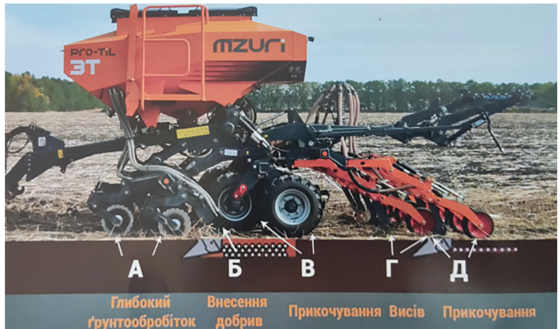
Рисунок 1 — Технологічні операції, які робить сівалка за один прохід
