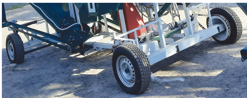
Рисунок 2 — Сепаратор для очищення і калібрування (сепаратор імпелерний ICM-30) з циклонно-осадовою камерою (ЦОК)
