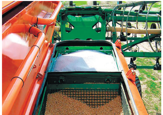
Рисунок 3 — Бункер для насіння і добрив
