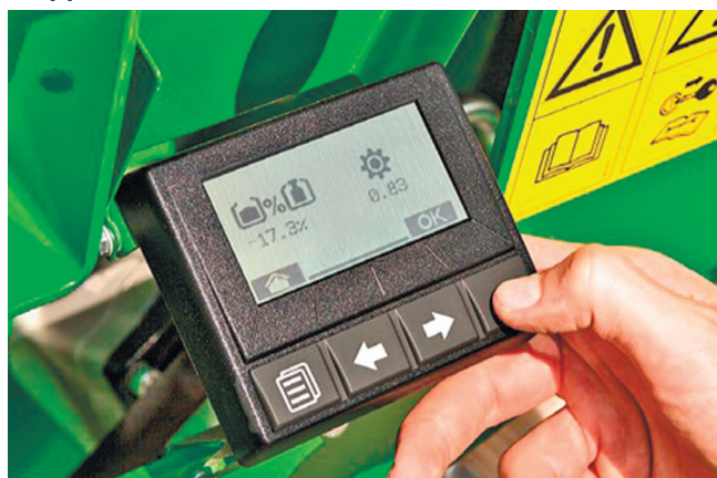
Рисунок 6 — Калібрування сівалки виконується швидко і без труднощів
