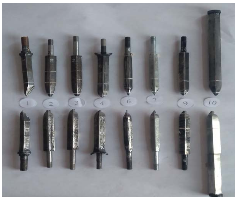
Рисунок 2 – Загальний вигляд зразків пальців до і після випробувань
