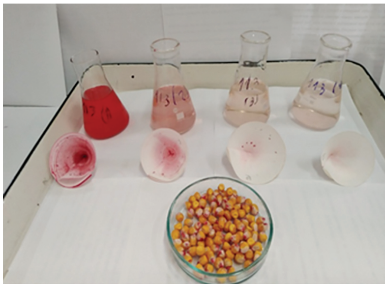
Рисунок 1 – Отриманий розчин після відмивання 100 насінин для визначення оптичної густини
