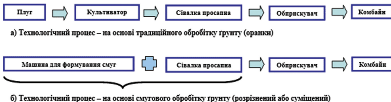
Рисунок 2 – Матриця реалізації обробітку ґрунту базовими комплексами машин
