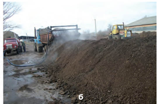
Рисунок 3 – Водорозподільний пристрій для серійного розкидача органічних добрив типу «ПРТ-10» (рис.3 а) і технологічний процес переформування бурту зі зволоженням сировини (рис.3 б)
