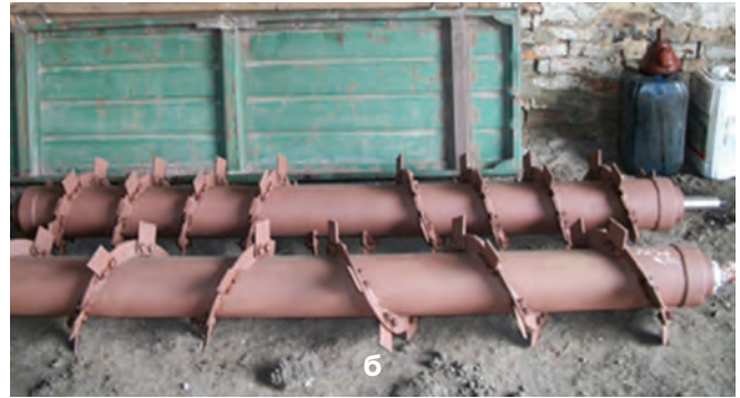
Рисунок 1 – Серійні робочі органи розкидача (рис. 1, а) і пристрій зі змінними барабанно-фрезерними робочими органами (рис. 1, б)
