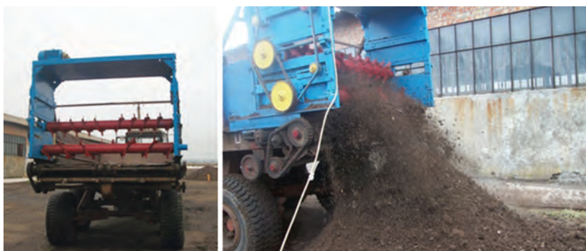
Рисунок 5 – Загальний вигляд модернізованого розкидача органічних добрив «ПРТ-10» і технологічний процес роботи
