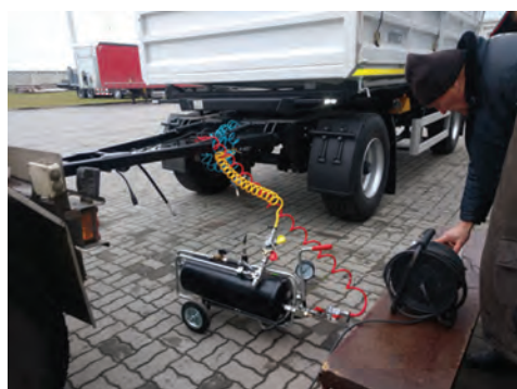
Рисунок 4 – Робочий процес вимірювання часу спрацювання гальм
