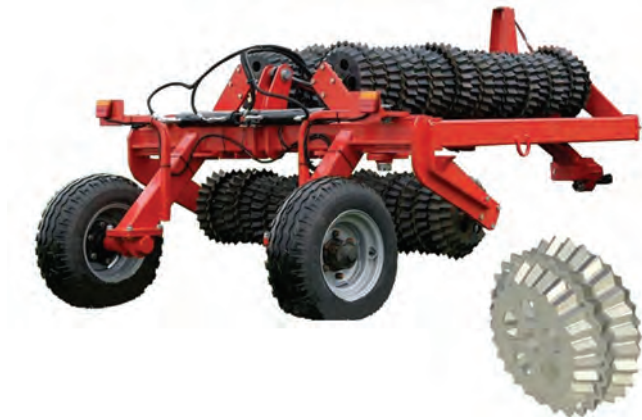
Рисунок 1 – Загальний вигляд котка «СТЕП КПП-6» і його робочого органа
