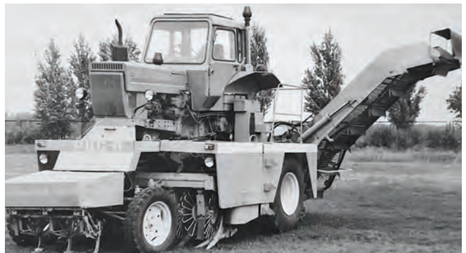
Рисунок 16 – Коренезбиральна машина «РКС - 6»
