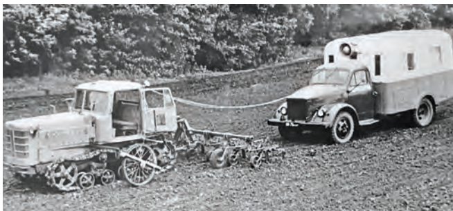
Рисунок 13 – Тензометрування сільгоспмашин із застосуванням пересувної тензолабораторії
