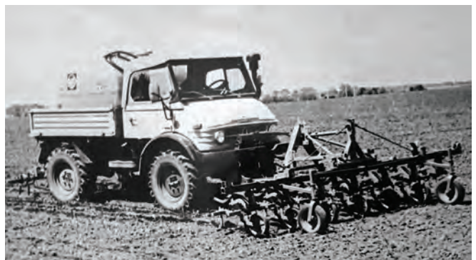
Рисунок 17 – Трактор «Unimog» в агрегуванні з культиватором «РАУ» на передній навісці, 1974 р.
