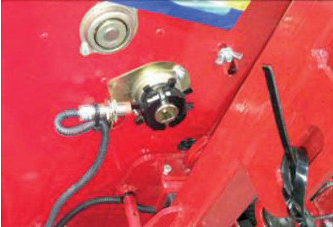
Рисунок 4 – Датчик контролю обертання вала дозатора
