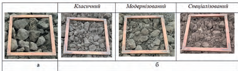
а – до проходу котка; б – після проходу котків на середній швидкості 7 км/год
