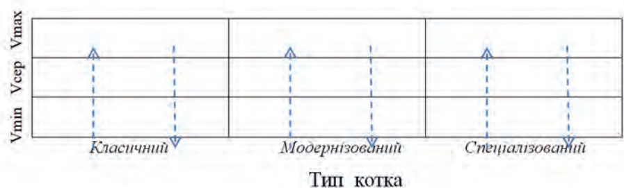
Рисунок 2 – План експерименту для визначення iнтенсивностi подрiбнення грудок кiльчасто-шпоровим i зубчато-шпоровим котками (грудкобiйний ефект)
