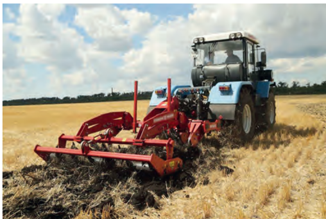
Рисунок 1 – Ґрунтообробний агрегат ХТЗ-17221 + глибокорозпушувач ГРУ-2,5 в роботі
