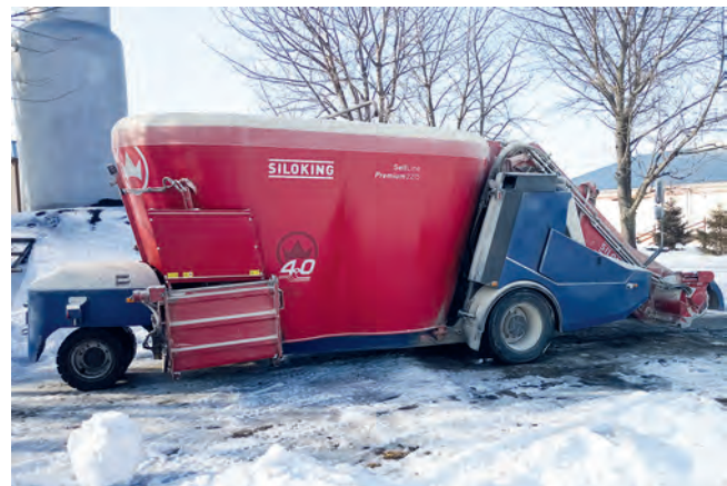
Рисунок 1 – Самохідний змішувач-роздавач Siloking SelfLine 4.0 Premium 2215
