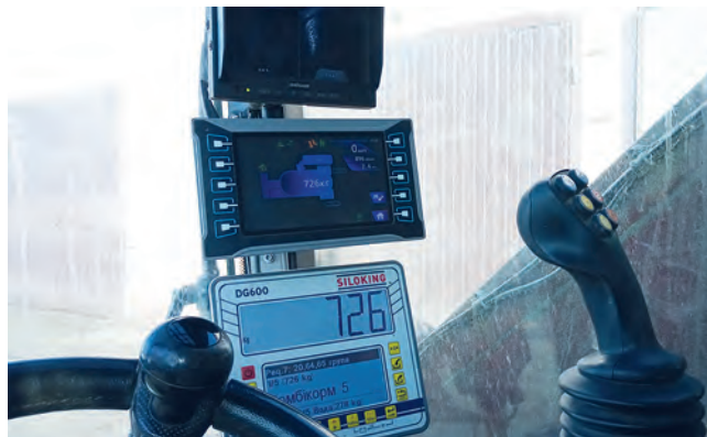
Рисунок 2 – Дисплей контролю завантаження кормових компонентів
