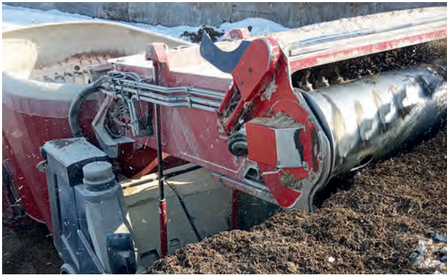
Рисунок 4 – Фреза самозавантажувального пристрою
