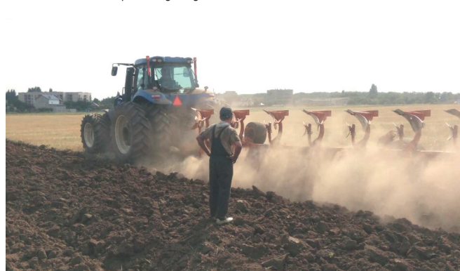
Рисунок 6 – Закладання ділянки під оранку трактором New Holland та 8-корпусним плугом оборотним (DRAGON) 30-32 см
