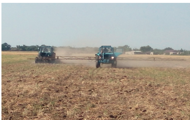
Рисунок 2 – Внесення деструкторів з одночасним загортанням у ґрунт
