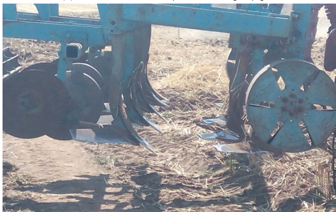
Рисунок 3 – Вигляд робочих органів КЛД -4 перед обробітком ґрунту на глибину 12-14 см
