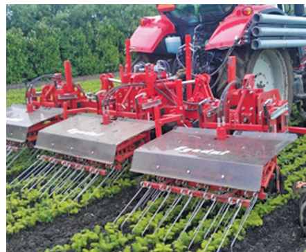
Рисунок 6 — Активні пружинні борони фірм «Egedal» (а) і «Elco» (б)
