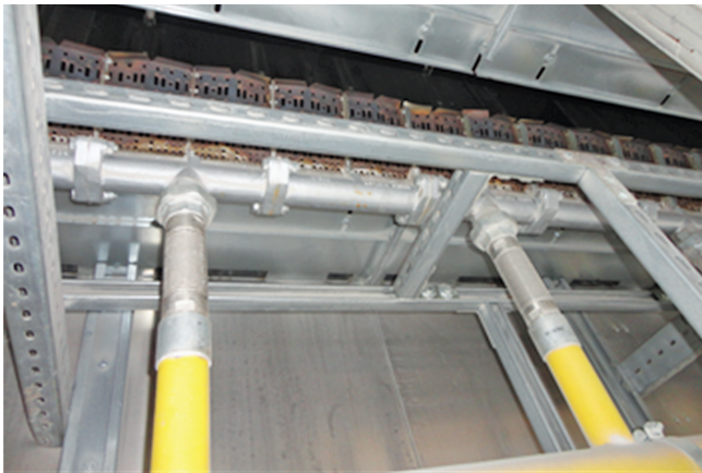
Рисунок 3 — Плоский газовий пальник (загальний вигляд у складі сушарки)
