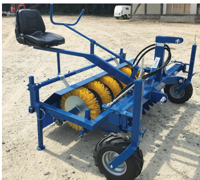
Рисунок 8 — Прополувальні щітки фірм «SMZ» (а) та «FOBRO» (б)
