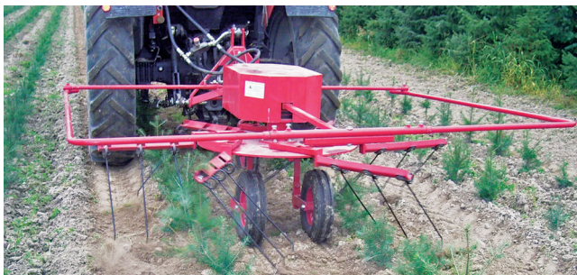
Рисунок 7 — Карусельна борона фірми «Egedal»
