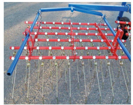
Рисунок 5 — Прополочна борона (а) та її секція (б)
