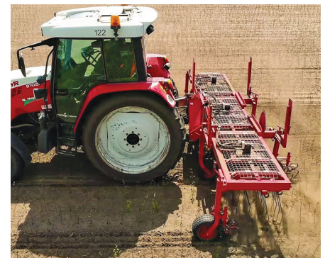
Рисунок 6 — Активні пружинні борони фірм «Egedal» (а) і «Elco» (б)
