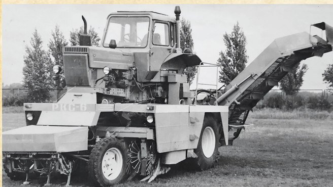
Рисунок 16 — Коренезбиральна машина «РКС – 6»
