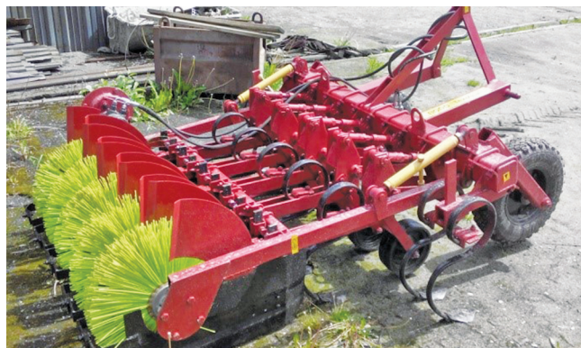
Рисунок 9 — Культиватор лісовий для міжрядного обробітку «КЛМ-1,4»
