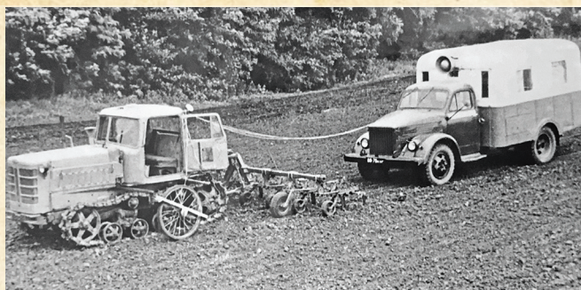
Рисунок 13 — Тензометрування сільгоспмашин із застосуванням пересувної тензолабораторії
