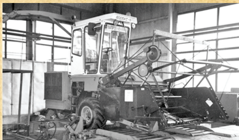
Рисунок 21 — Стенд для прискорених випробувань самохідних колісних машин
