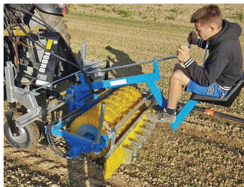
Рисунок 8 — Прополувальні щітки фірм «SMZ» (а) та «FOBRO» (б)
