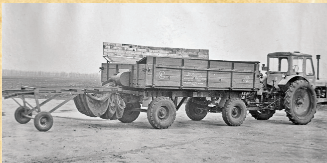
Рисунок 12 — Загальний вигляд агрегату для відбору проб за бурякозбиральними комбайнами
