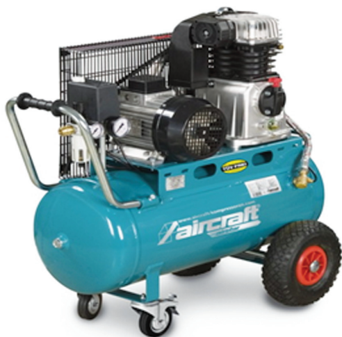
Рисунок 5 — Повітряний компресор пневмосистеми
